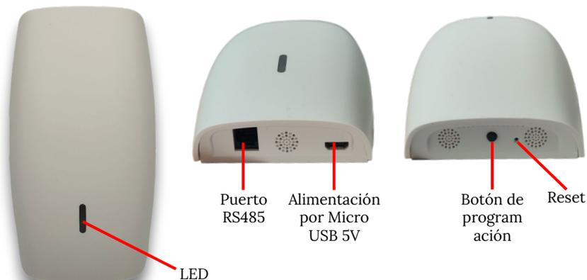
SmartBox es un receptor inteligente, que le permitirá vincular, controlar y ajustar personalmente el funcionamiento de sus motores de persiana, toldo y cortina mediante una red WIFI. De esta manera podemos interactuar con los motores a través de aplicaciones como Alexa, Google Home, IFTTT, entre otras, gracias a la aplicación “Connector”.
